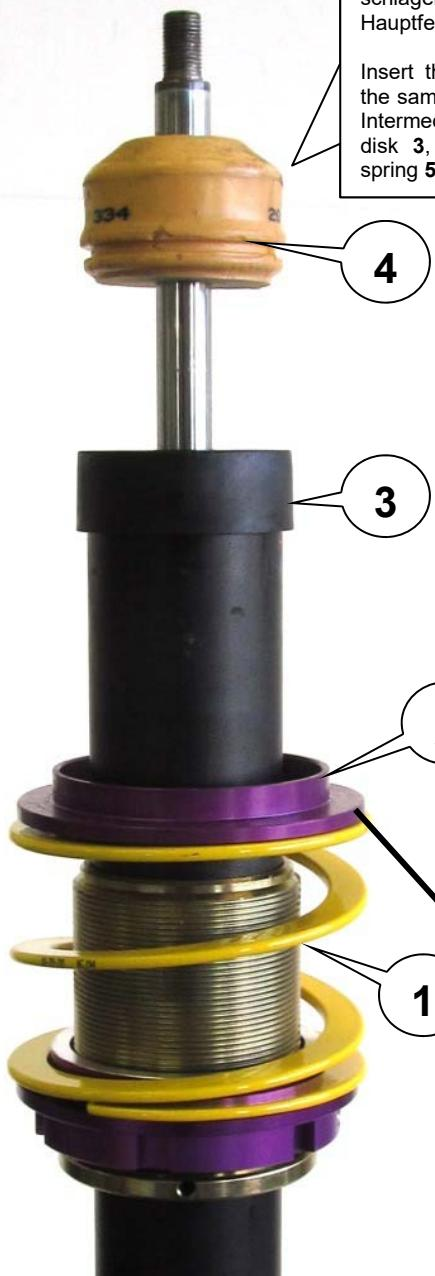
Folgende mitgelieferte Teile in der Reihenfolge auf das Federbein aufstecken: Vorspannfeder 1, Zwischenring 2, original Entlüfterscheibe 3, Anschlagelement 4, Stabschutz 5, Hauptfeder 6 und Federteller 7.
