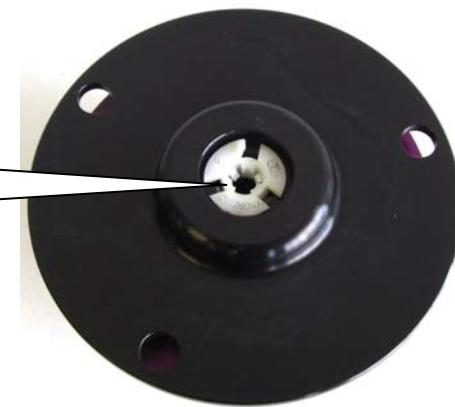
Die HA-Verstellung wird oben zwischen Feder und Karosserie montiert. Die serienmäßige obere Federunterlage wird weiterverwendet. Zum Korrigieren (verdrehen des Gewinderings) der Fahrzeughöhe, ist die HA-Verstellung aus dem Fahrzeug zu demontieren.
