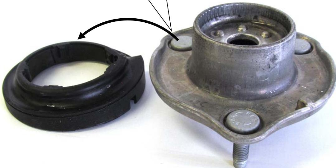
Original Stützlager aufstecken und mit der Original Mutter verschrauben. Die Montagehinweise zum Einbau des Federbeines in das Fahrzeug, sowie die Anzugsdrehmomente der Federbeinbefestigung, entnehmen Sie bitte den Unterlagen des Fahrzeugherstellers.
