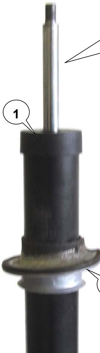
Original Feder, original Anschlagelement und original Staubschutz vom Federbein demontieren. Anschließend die aufgepresste Entlüfterscheibe (1) und den aufgepressten Federteller (2) von dem Dämpfer abziehen.
